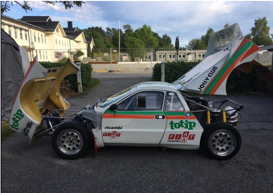
Bild 2. Under karossen i kevlarkomposit döljer sig en rallykonstruktion.
