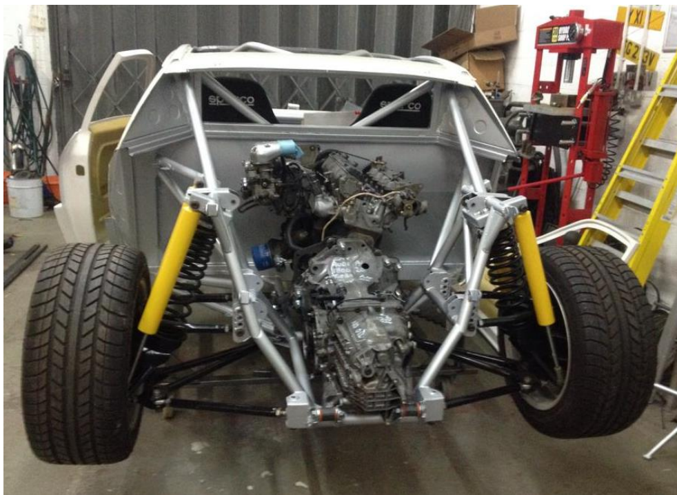
Bild 4. Under byggnationen av Mick Covill. Precis som Montecarlon har bilen en mittmonterad motor, dock nu kompressormatad (se vänster sida) och längsmonterad för att möjliggöra en justerbar hjulupphängning lämplig för olika rallyförhållanden.
