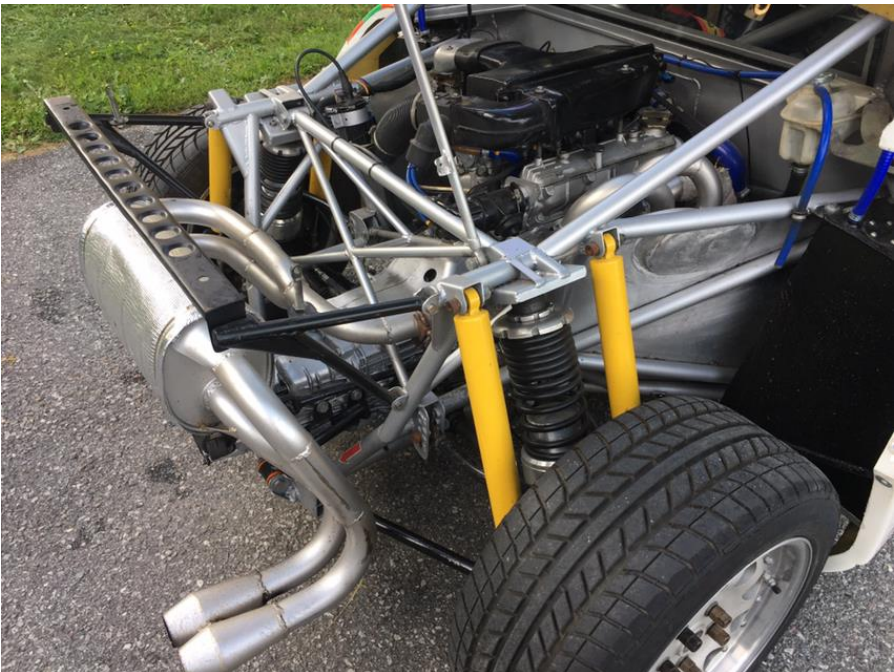
Bild 3. Mittmonterad motor, avgassystem och justerbar hjulupphängning.
