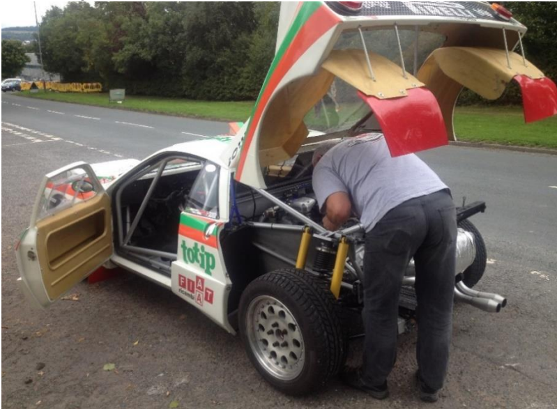
Bild 7. Helt plötsligt vid provkörningen gick motorn inte som den skulle och bilen stannade. Snabbt som attan ålade sig Mick ur bilen, öppnade bakhuvens och upptäckte att gasvajern lossnat i sitt förgasarfäste. Problemet var åtgärdat.
